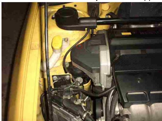
A cette étape nous allons desserrer légèrement de 3 ou 4 tours les 3 vis sur le support moteur ainsi que l'écrou sur le support élastique avec le moteur sans contrainte par l'action du cric qui se fera à l'étape suivante.
