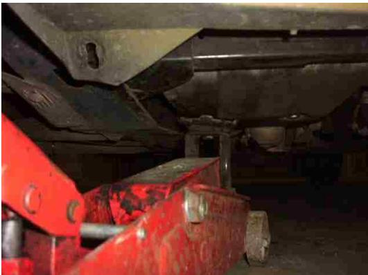
Apr s certitude du bon positionnement du cric il vous faudra retirer les 3 vis et l'ecrou pr cedement citer puis deposer le support moteur. maintenant il est interdit de bouger la voiture ou de remuer le moteur.
