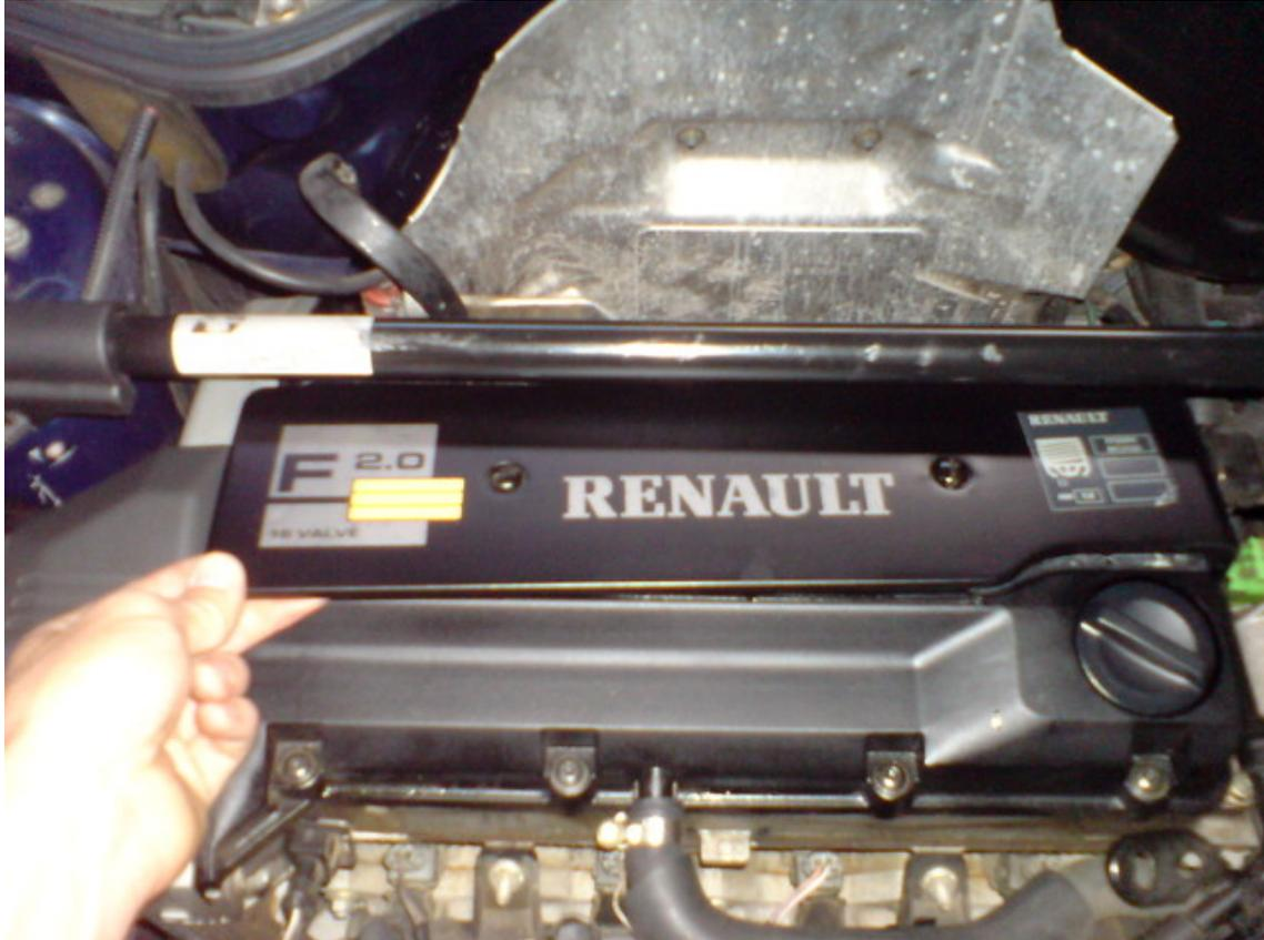
on vient ensuite declipser les enjoliveurs de barre anti rapprochement, et avec la clef de 13 on enlève la barre
