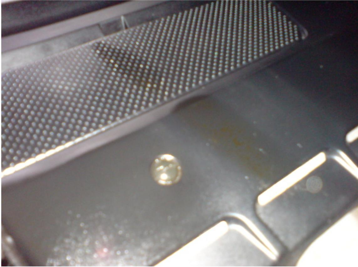
le cache moteur s'en va en tournant les deux vis d'un quart de tour
