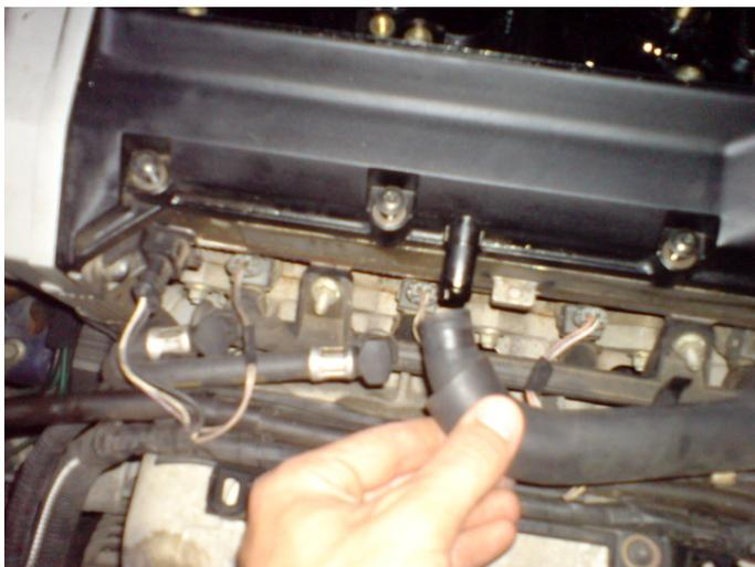
et la on dessere un peu les vis de couvre culasse, 16 vis torx de 30
