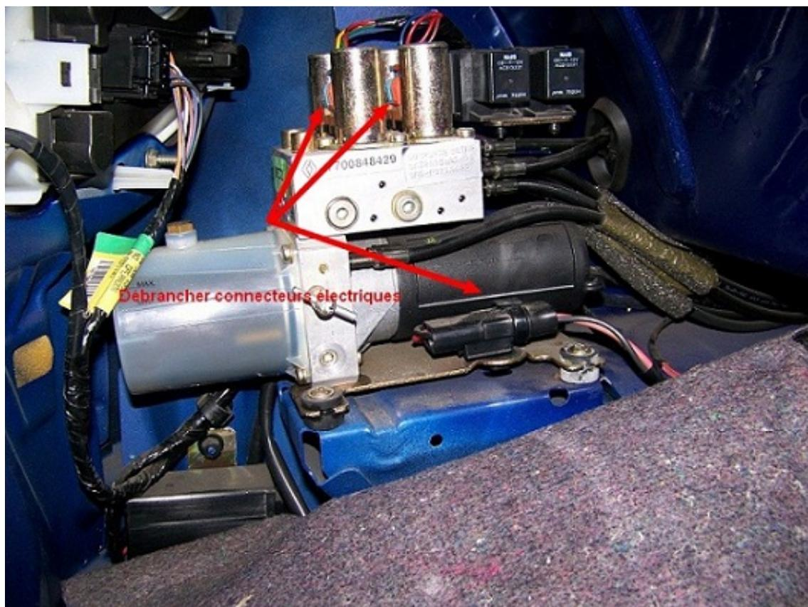
Ensuite, on a donc notre bloc moteur/pompe libre. Il ne reste plus qu'à enlever les 2 vis torx de 25 qui relient le moteur électrique à la pompe hydraulique.
