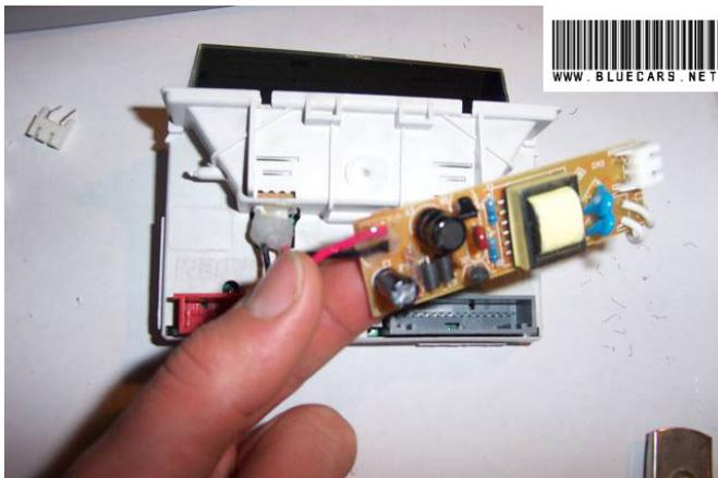
Ranger et coller la balaste derriere l'afficheur :
