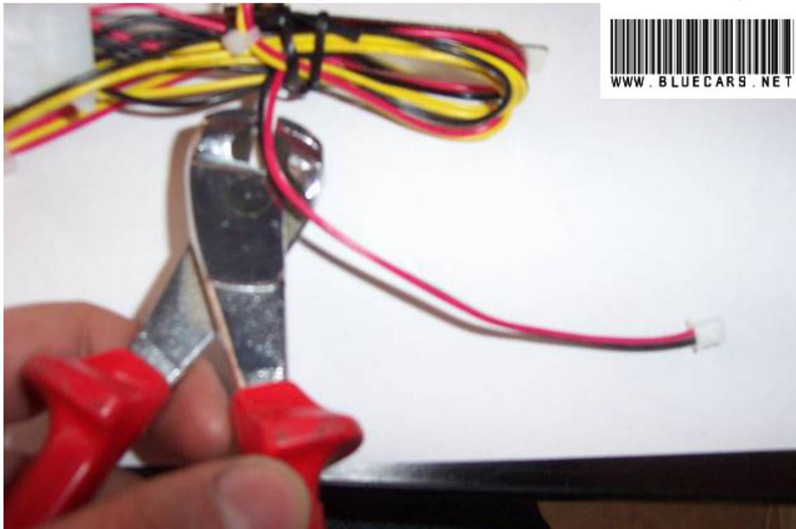
On fait de même avec les deux fils du négatif. On peut laisser le connecteur mais moi j'ai raccourci les fils et encore soudé. Comme ça moins de fils derrière l'afficheur.
