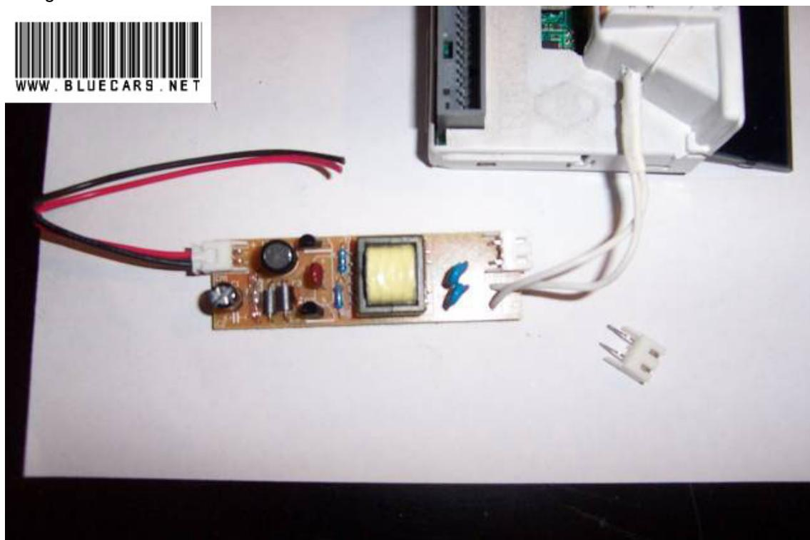
Ensuite, il faut relier la balaste Ã une alimentation. La meilleure solution, repiquer le jus sur les supports d'ampoules d'origine.
