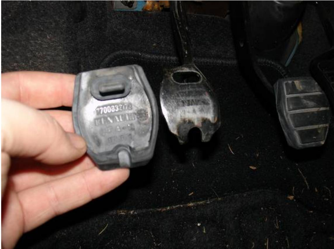
Détail de la nouvelle qui se fixe par vis sur les modèles d'origine
