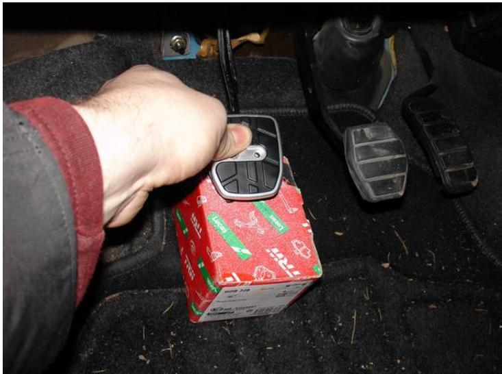
AVANT LE PERCAGE, fixez la nouvelle pédale avec du scotch ou double face afin de vérifier si rien ne gêne lors de des mouvements de la pédale.
