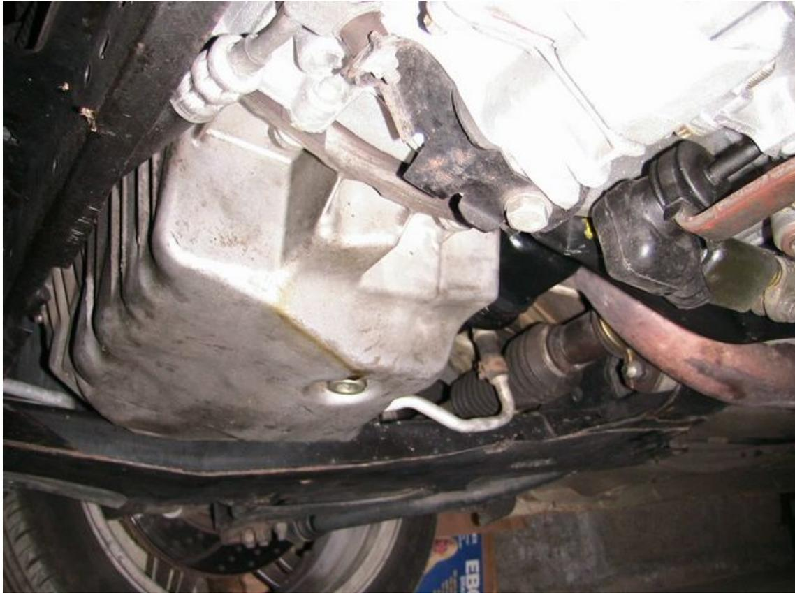
A cette étape, il faut retirer la partie avant du passage de roue de droite ( passage) il y a 2 pions et 2 ou 3 petites vis Torx.
