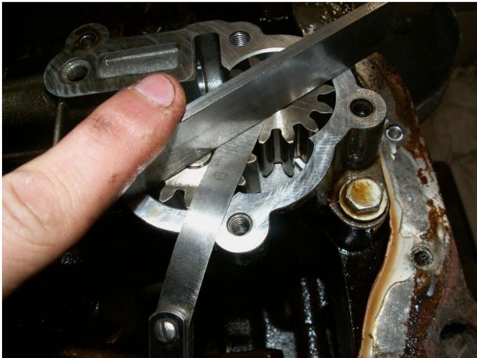
de plus notre pompe a huile presente une usure du couvercle et du corp en dent de scie
