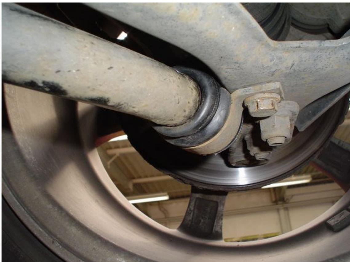
pour le serrage les vis se serrent a 3.2 daN.m
