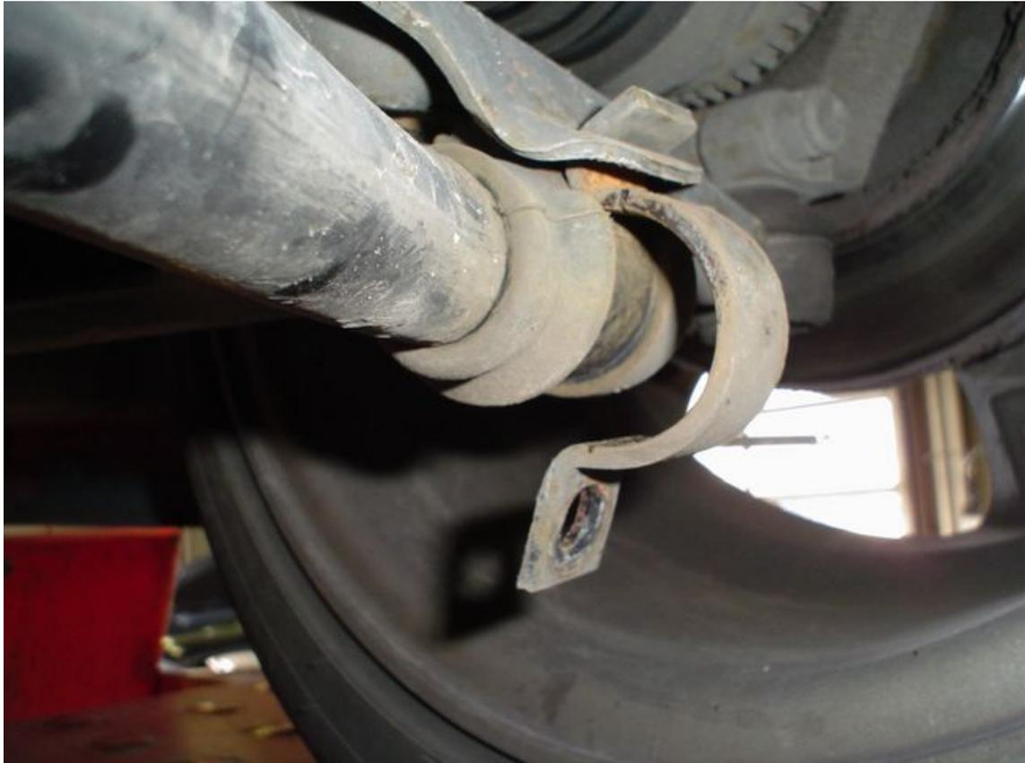
Deposer les fixations sur le berceau il y a aussi une visse et un ecrou de 13
