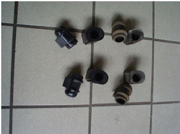
mettre en place les silent blocs neuf
