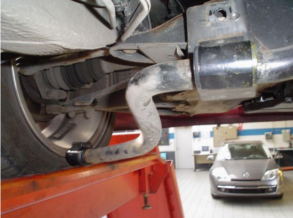
une fois les quatres silent blocs en place remettre la barre a sa place , sur les deux du milieu la fente vas vers le bas
